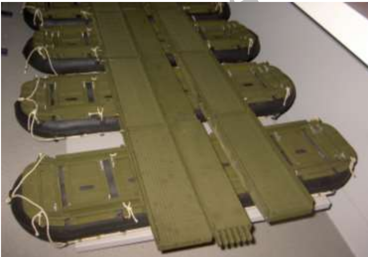
La maquette de Treadway du musée du Génie présente un élément de travure M2 entre les chemins de roulement permettant le passage de véhicules de voie inférieure à 3,30 m.
